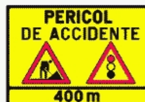
Presemnalizarea unui sector cu circulație alternantă
