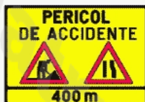
Presemnalizarea unui sector cu circulație alternantă
