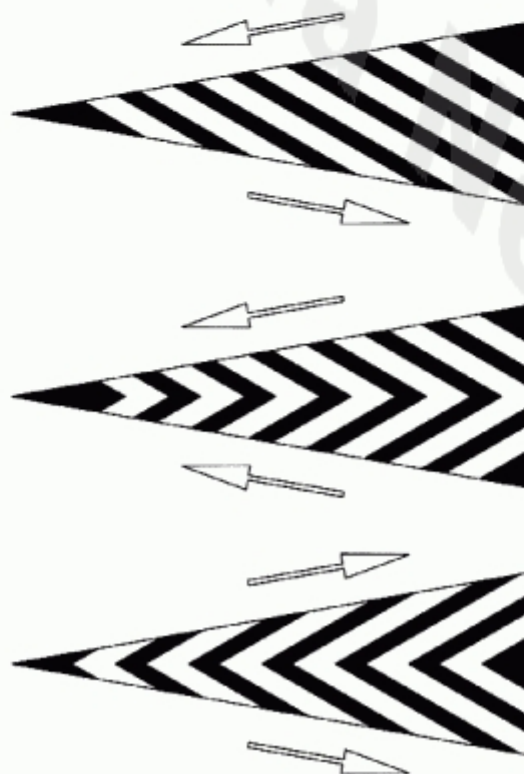
Spații interzise circulației
