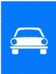
Drum pentru autovehicule
