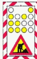
Semnalizarea unui utilaj care se deplasează lucrând
